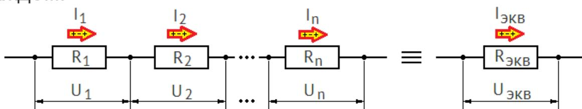
$n$  последовательно соединенных проводников всегда можно заменить одним эквивалентным проводником. Сила тока  $I_{\text{ЭКВ}}$  через этот проводник, напряжение  $U_{\text{ЭКВ}}$  на нем, а также его сопротивление  $R_{\text{ЭКВ}}$  будут определяться по правилам, отображенным в таблице.
