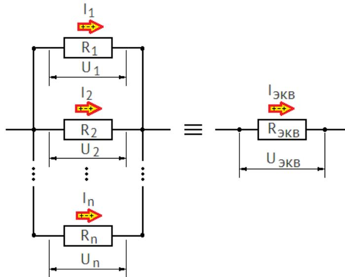
$n$  параллельно соединенных проводников всегда можно заменить одним эквивалентным проводником. Сила тока  $I_{\text{ЭКВ}}$  через этот проводник, напряжение  $U_{\text{ЭКВ}}$  на нем, а также его сопротивление  $R_{\text{ЭКВ}}$  будут определяться по правилам, отображенным в таблице.
